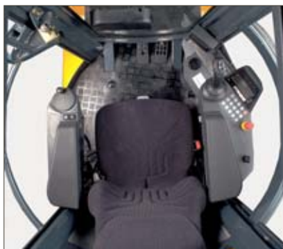
Poste de conduite avec commandes intégrées au siège
